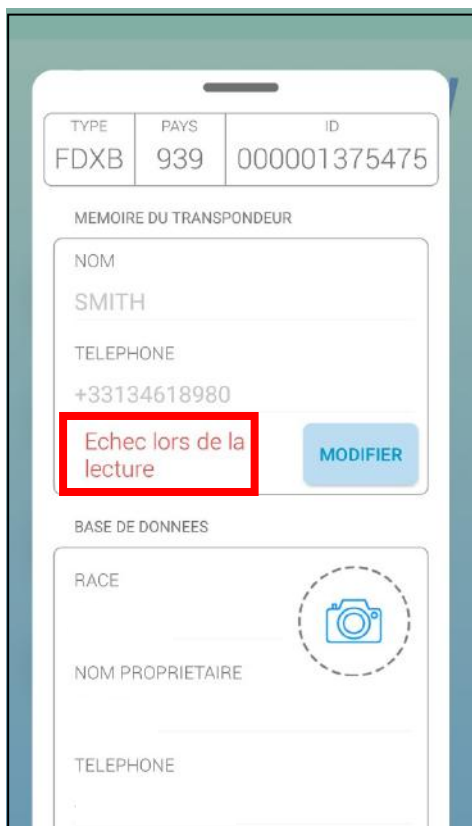
Echec de l'écriture : - puce trop éloignée du lecteur - zone mémoire non ouverte
